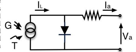
Fig. 7. Solar PV circuit.
